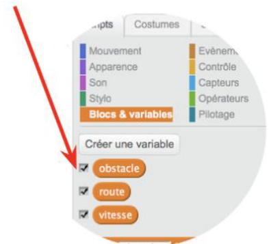
Puis, dans le programme, on stocke la **valeur mesurée par le capteur** à ultrasons dans la **variable**.
