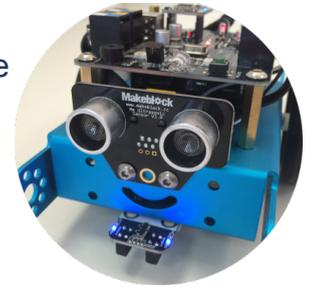
On commence par créer la **variable** « **obstacle** » qui permettra de stocker la valeur correspondant à la **distance des obstacles** mesurée par le capteur à ultrasons.
